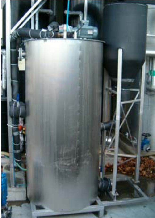
Figur 1. Anaerob bioreaktor som användes i försöken. Längst upp till höger syns försedimenteringen som användes i försök 0 och 1.
