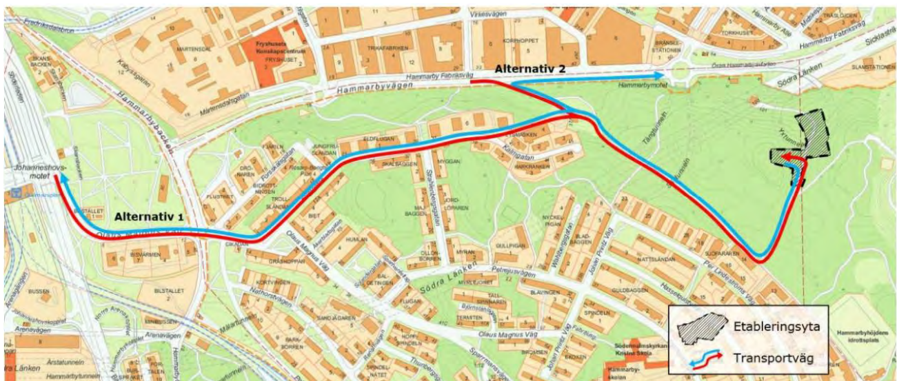
Figur 20. Föreslagna transportvägar från påslag Hammarbyskogen (NÖTp1).
