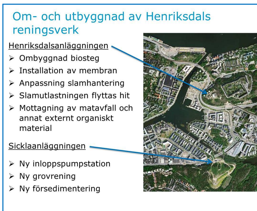
Figur 1 Översikt över Sickla och Henriksdalsanläggningarna
