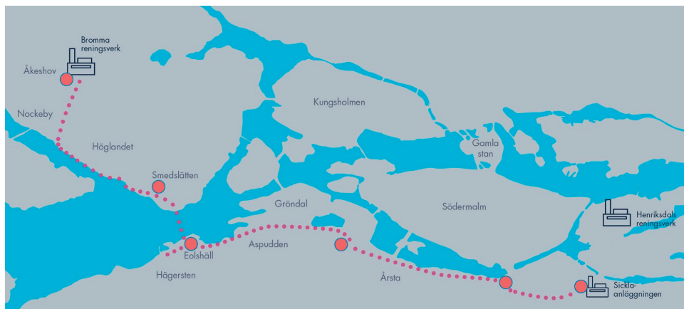
14 km tunnel. Tunnelsträckningen från Bromma till Henriksdals reningsverk. Sex etableringar anläggs under byggtiden.
