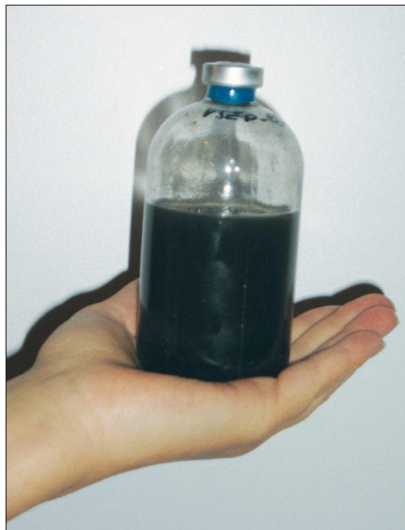
Bild 1 Testflaska, minirötkammare, som använts vid aktivitetstest.
