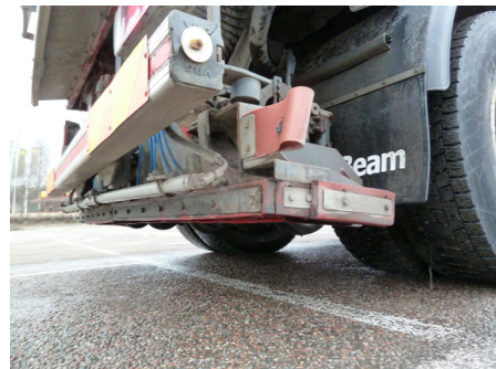
Tvättning och vakuumsugning av en yta med genomsläpplig asfalt.
